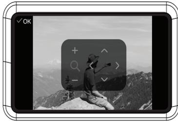
**HINWEIS:** Möglicherweise muss der Bildausschnitt vor Beginn der Aufnahme angepasst werden. Dies kann einfach am Gerät vorgenommen werden. Verschieben Sie das Bild oder zoomen Sie hinein oder heraus, um den Film richtig einzurahmen. Es ist wichtig, den Bildausschnitt der Kamera einzustellen, damit der Scanner den Film effizient aufnimmt.
