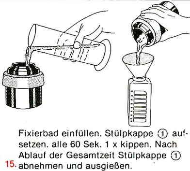
15. Fixierbad einfüllen. Stülpkappe (1) aufsetzen. alle 60 Sek. 1 x kippen. Nach Ablauf der Gesamtzeit Stülpkappe (1) abnehmen und ausgießen.
