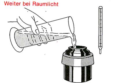
9. Weiter bei Raumlicht Vortemperierten Entwickler einfüllen
