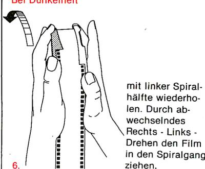
6. Bei Dunkelheit mit linker Spiralhälfte wiederholen. Durch abwechselndes Rechts - Links - Drehen den Film in den Spiralgang ziehen.
