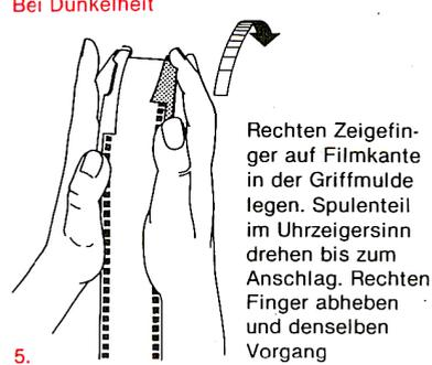
5. Bei Dunkelheit Rechten Zeigefinger auf Filmkante in der Griffmulde legen. Spulenteil im Uhrzeigersinn drehen bis zum Anschlag. Rechten Finger abheben und denselben Vorgang
