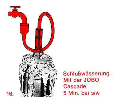
16. Schlußwässerung. Mit der JOBO Cascade 5 Min. bei s/w
