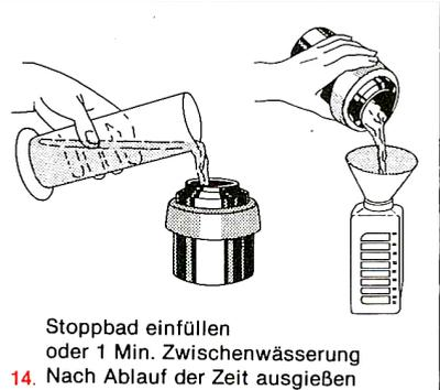
14. Stopfbad einfüllen oder 1 Min. Zwischenwässerung Nach Ablauf der Zeit ausgießen
